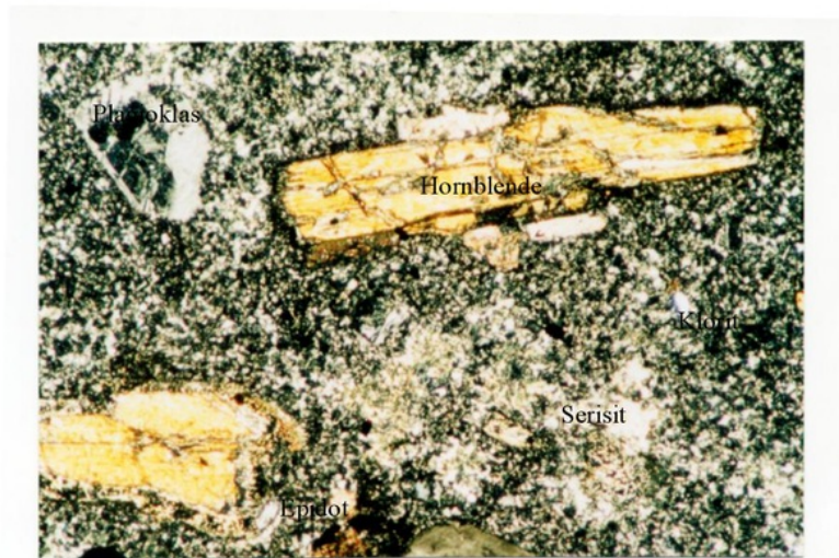
Foto 1 Sayatan petrografi lokasi daerah Sangon terdapat andesit yang terpropilitisasi. Mineral hornblende sebagian berubah menjadi serisit, klorit dan epidot .
