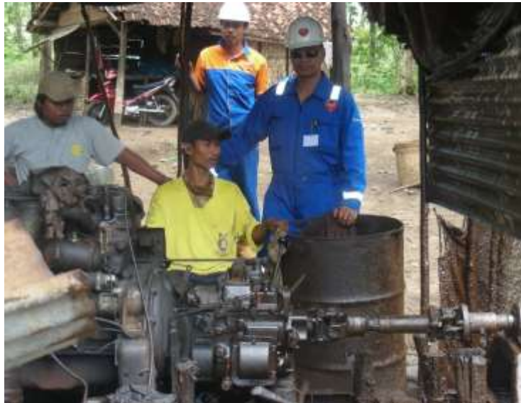
Gambar 12. Proses Produksi Sumur Tua dengan Teknologi Timba Mekanis
