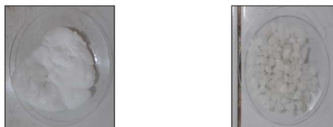
Gambar 3. HPAM hasil sintesis (a) belum dioven (b) sudah dioven
