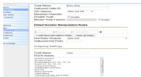
Fig. 14. Konfigurasi Trunk Asterisk untuk Avaya
