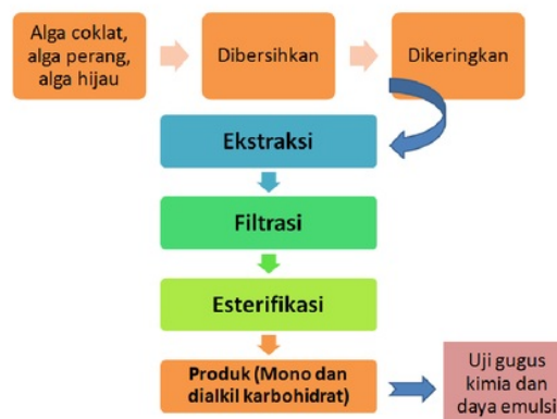
Gambar 2. Diagram alir proses pembuatan dialkil karbohidrat
