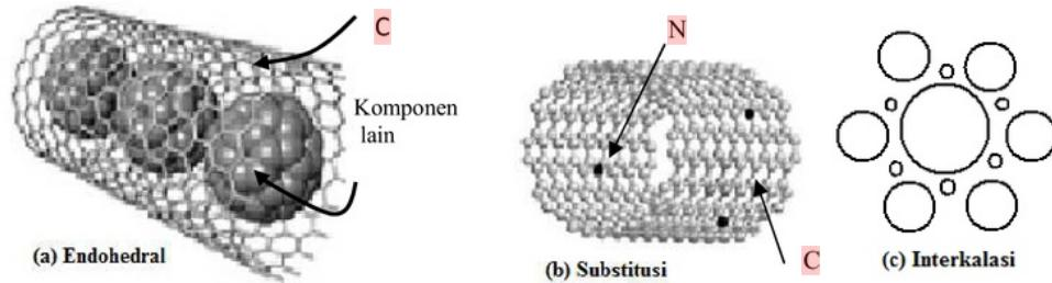
Gambar 8. Bentuk ikatan CNT dengan komponen lain.
