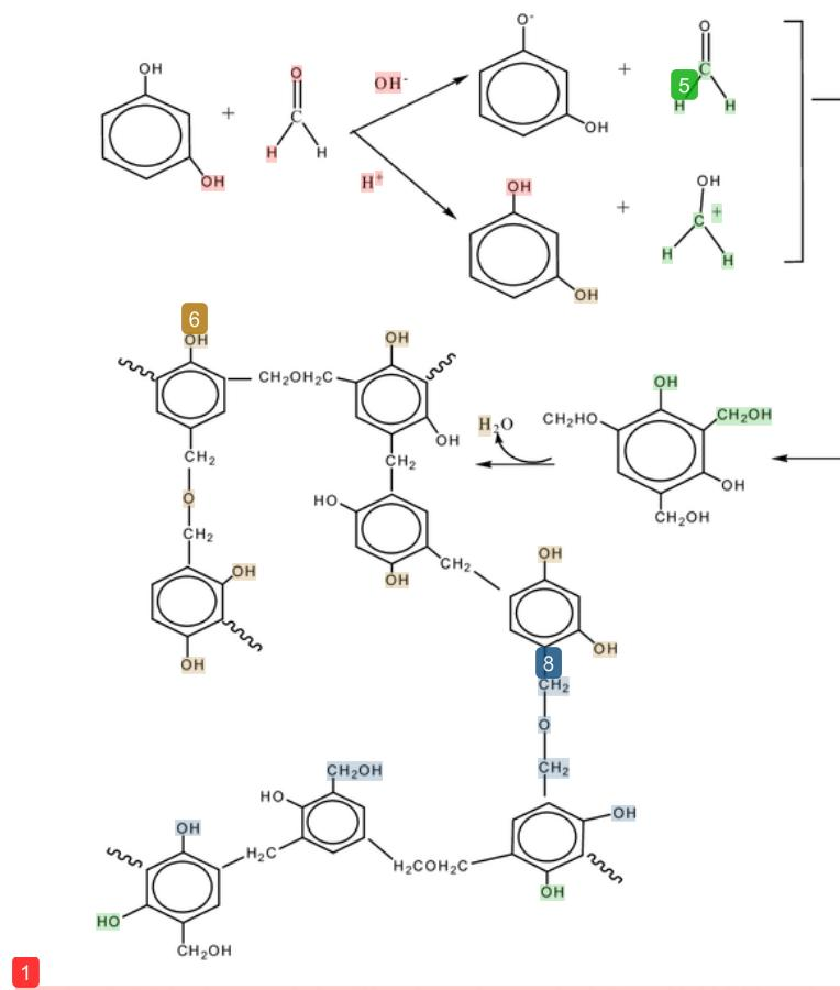
Gambar 3. Mekanisme reaksi polikondensasi resorcinol-formaldehid (Regalbuto, 2006).
