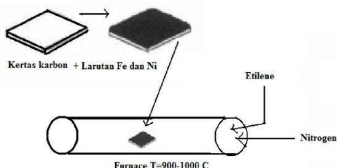
Gambar 4. Sintesis katalis Ni-Fe/CNT-N menggunakan CVD.
