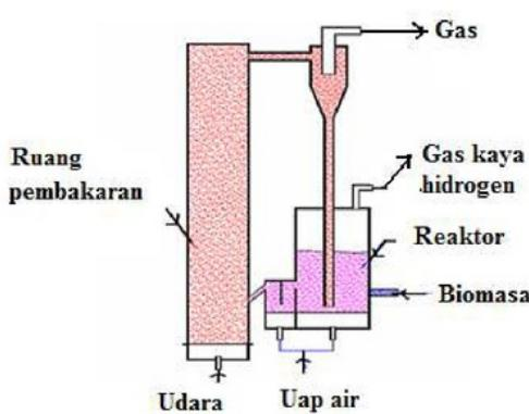
Gambar 2. Reaktor gasifikasi biomassa (Shen et al, 2008).
