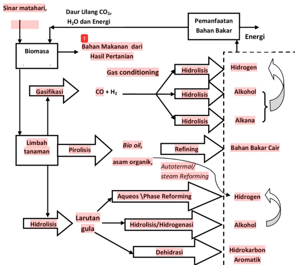
Gambar 1. Skema proses produksi hidrogen dari biomassa secara termokimia (Kirtay, 2011)
