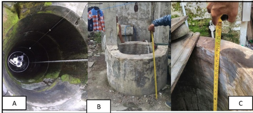
Gambar 4 : Pengukuran muka air tanah. A. Pengukuran kedalaman maksimum sumur. B. Pengukuran tinggi bis. C. Pengukuran muka air.
