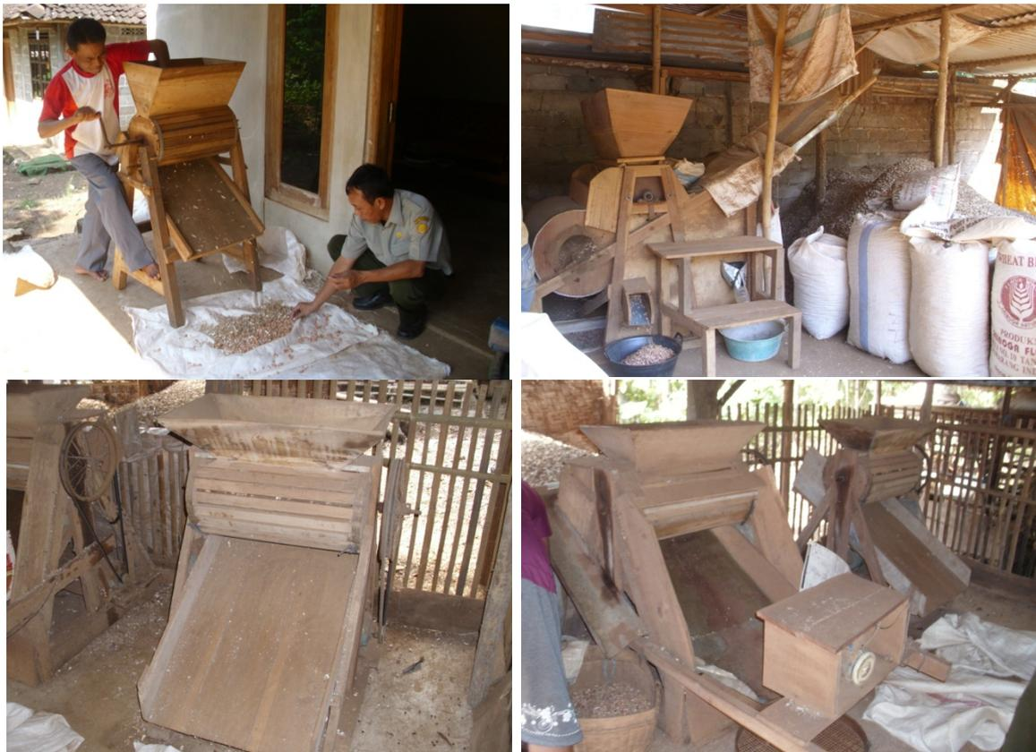
**Gambar 1.** Alat/mesin pengupas yang dilakukan pengujian
