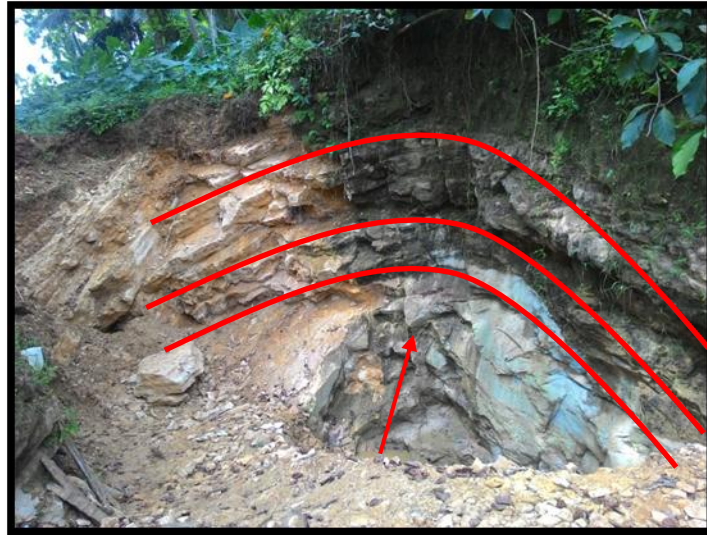
Gambar 4.12 Foto Kenampakan Lipatan Antiklin Pada Area Penambangan Batugamping tepatnya di poligon 1, Titik Pengukuran 1.
