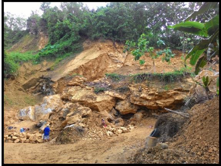
Gambar 4.15 Foto Gerakan Massa Batuan Pada Lokasi Penambangan Akibat Teknik Penambangan dan Curah Hujan di Poligon 1, Titik Pengukuran 3.
