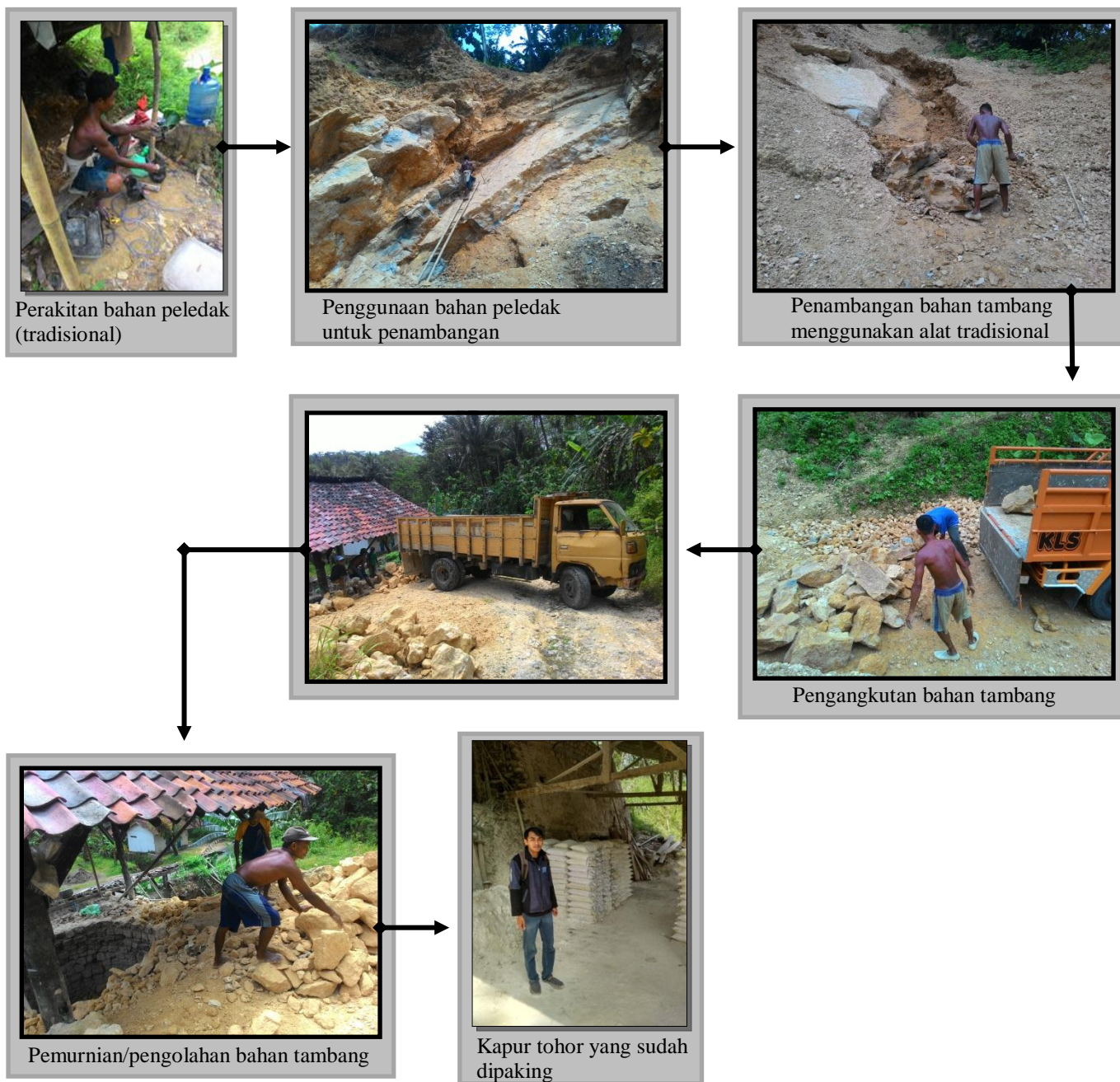
Gambar 2.1 Diagram Alir Proses Penambangan Batugamping di Desa Darmakradenan
