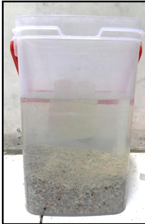
**Gambar 6.1 Percobaan Pencampuran Zeolit Alam dengan Air Payau dalam Toples**
