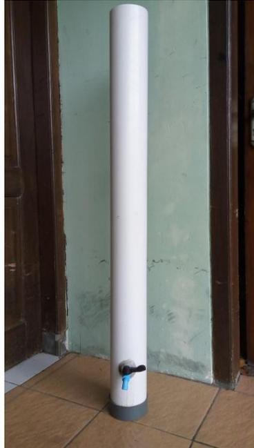
**Gambar 6.5 Percobaan Pencampuran Zeolit Alam dengan Air Payau dalam Pipa Berukuran Panjang 50 cm dan diameter 10,16 cm**
