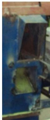
Gambar 4.22 *Waste output hole* sesudah modifikasi
